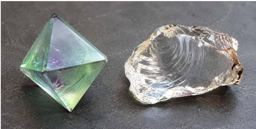
Abb. 3.2 Spaltbarkeit gegen Bruch: glatte Gitterebenen beim Fluorit, glasig-muschelige Bruchfläche beim Quarz.
